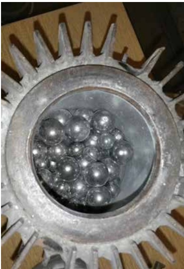
Abbildung 24 „Planet“ – Mahraum mit Mahlkörperfüllung (Quelle ECG)
