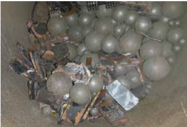
Abbildung 22 Hochleistungsplatinen in der Kugelmühle nach t_3 (Quelle ECG)
